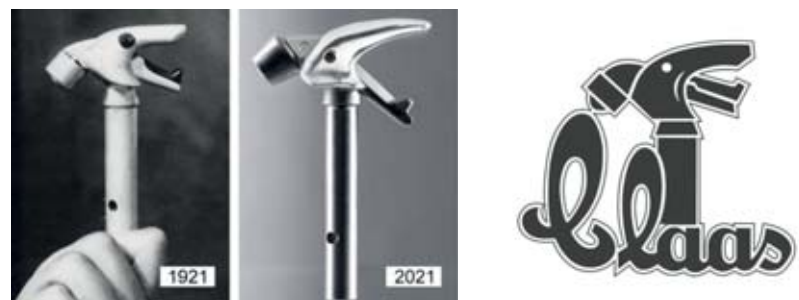
Figura 5.- Pajarito o pico atador de Claas. Izquierda, evolución en los primeros 100 años de vida. Derecha: Logotipo de Claas durante mucho tiempo. Doc: Claas.
