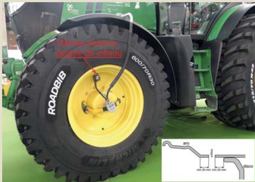
Figura 5.- Neumático dotado de sistema central de inflado y recomendación de la asociación europea de fabricantes sobre la posición en la llanta del orificio para la válvula.
