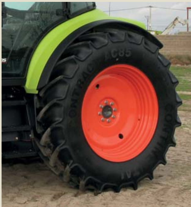
Figura 9.- Rueda de tractor con llanta del tipo TW por el triple pliegue de su perfil.
