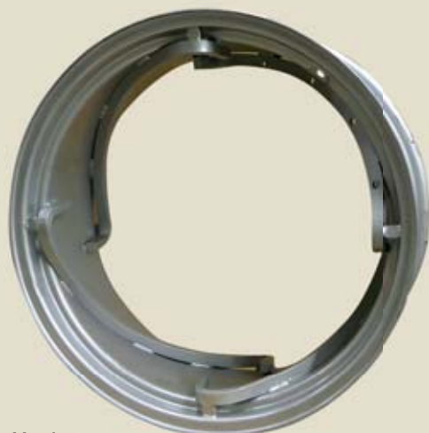
Figura 11.- Aro de llanta con pletinas helicoidales que permiten que el disco se atornille a ella en varios lugares para variar el ancho de vía del tractor.
