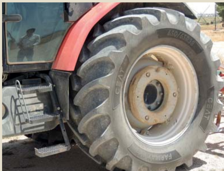
Figura 6.- Rueda con una masa sujeta al disco de la llanta para lastrar el tractor.
