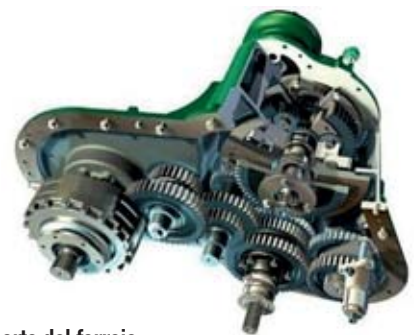
Derecha, Sistema IVLOC de John Deere para variar de manera continua la longitud de corte del forraje
