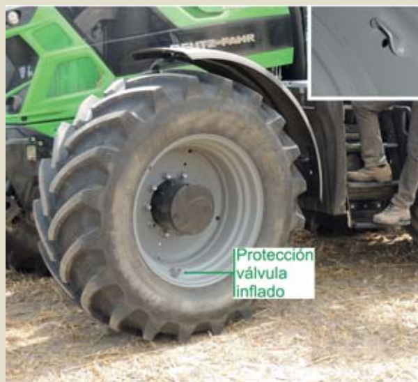
Figura 4.- Llanta con pliegue para proteger la válvula de inflado del neumático y detalle del mismo.
