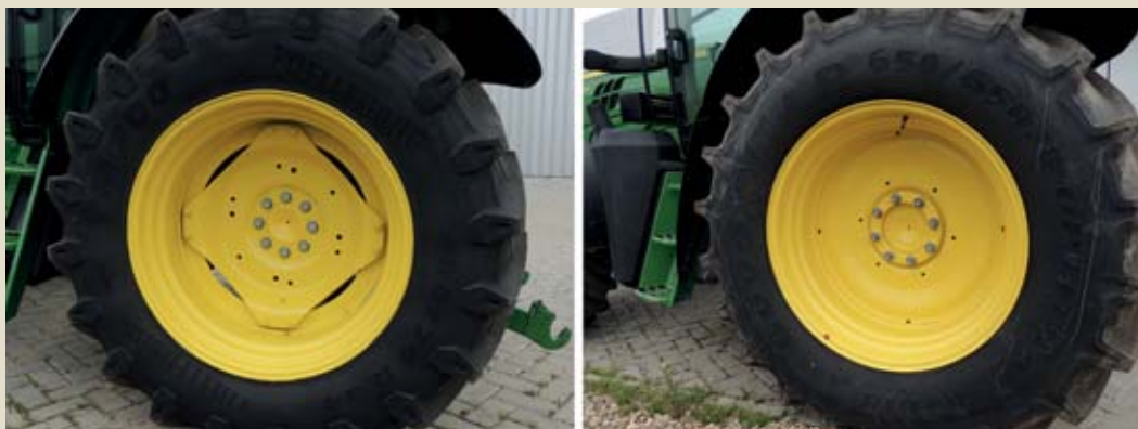
Figura 10.- Rueda con llanta formada por disco y aro atornillados (izquierda) y disco y aro soldados (derecha).
